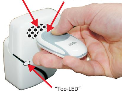
Nach Ablauf der drei Sekunden führt der ggf. angeschlossene Motor eine kurze Fahrt durch (Zucken). Dies ist auch an der Status LED "Top LED" erkennbar (kurzes Aufleuchten). Dies ist hilfreich, sofern noch kein Motor angeschlossen ist. Sollte der Motor sich in einer Endlage befinden, erfolgt das Zucken unter Umständen nicht, die LED leuchtet aber auf alle Fälle auf. Die Taste am Handsender muss jetzt losgelassen werden.
