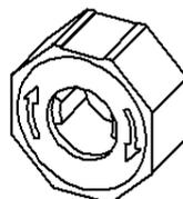
Mitnehmer ohne ABS auf den Getriebezapfen stecken, die Pfeile auf der weißen Kunststoffscheibe haben keine Bedeutung. Anschließend Sicherungsring aufstecken.
