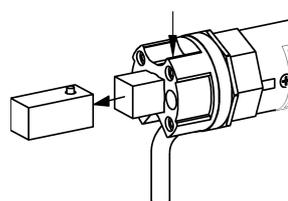
Zum Ausbau des Vierkants wird mit einem Stift der Arretierbolzen zurückgedrückt und der Vierkant herausgezogen.
