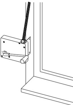
Exemple 2: si l'enrouleur dépasse le coin du mûr après montage, utiliser notre équerre de fixation pour meilleure fixation.
