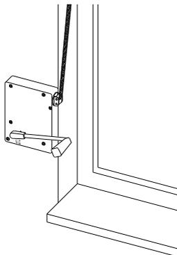
Exemple 1: utiliser que des guides sangle royales de SIRAL (roulement à aiguilles).
