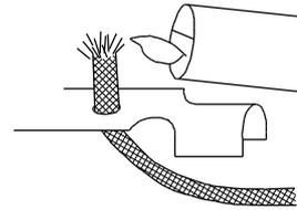
1. Insérer le cordon dans le trou du feuillard d'acier et brûler légèrement l'embout avec le briquet.
