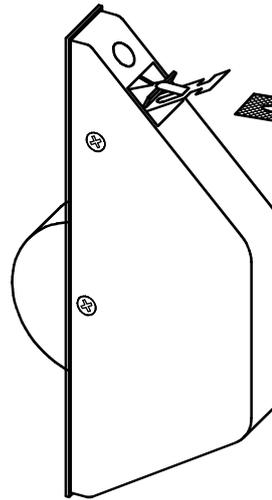
Gurt nach ca. 15 mm lochen ( nicht nur Längsschlitz anbringen, da sonst der Gurt im Wickler streift ).
