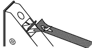
Erst danach mit dem Gurt das Federende etwas herausziehen und die Arretierlasche aushängen. Feder ist gespannt - Verletzungsgefahr!
