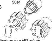
Mitnehmer ohne ABS auf den Getriebezapfen stecken, anschließend Halteklammer einstecken
